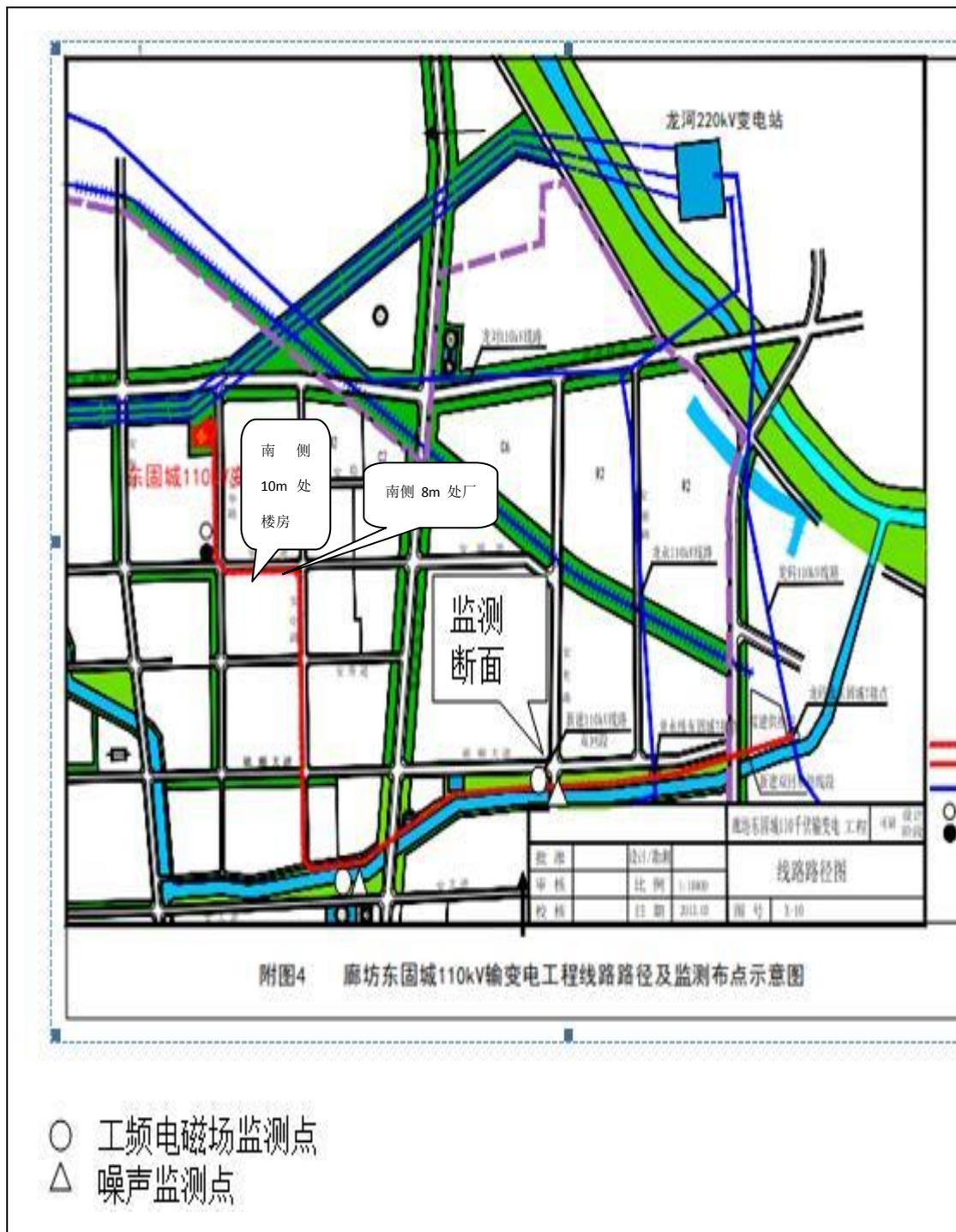
附图 4 东固城 110kV 输变电线线路路径示意图
