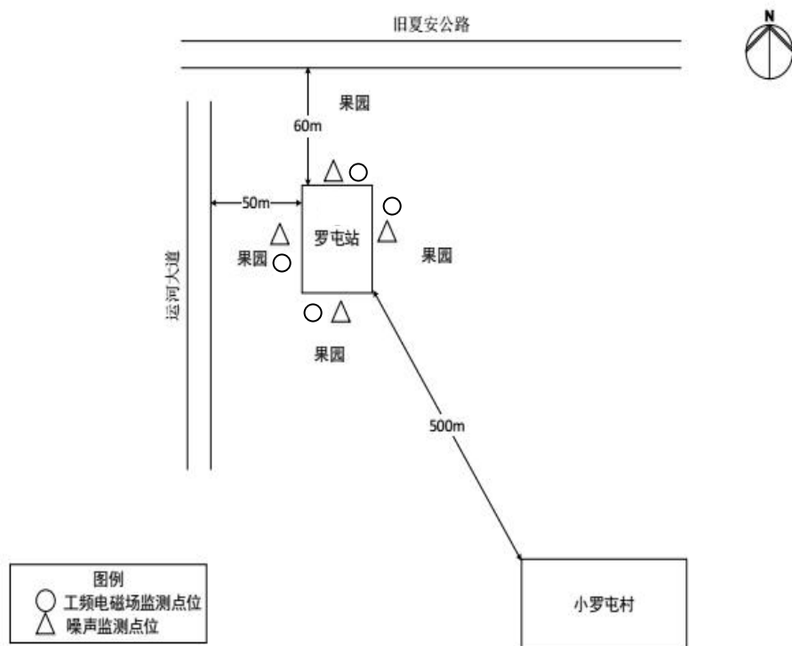
罗屯 110kV 变电站监测点位示意图
